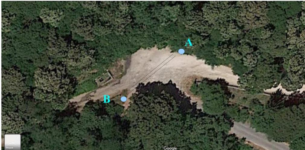
Foto n.4. Ortofoto con individuazione del tracciato del tubo interrato di smaltimento acque meteoriche AB in località Marcaccio.
