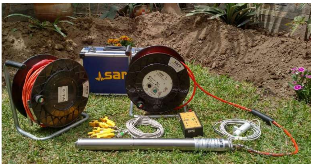
Foto n.2 – Attrezzatura prova down-hole in dotazione della Società EdilTest
