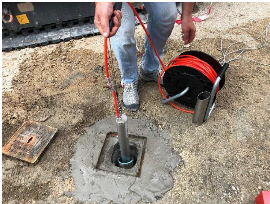
Foto n.1 – Realizzazione prova DOWN-HOLE
