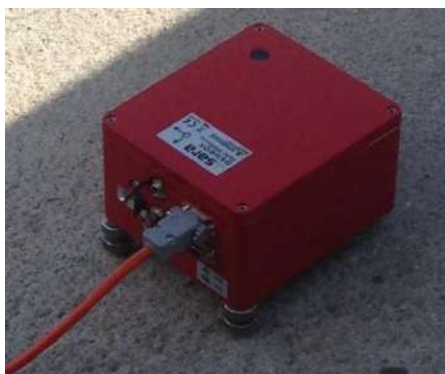
Foto n.4 – Sismografo GEOBOX, stazione singola di registrazione (analisi HVSR).
