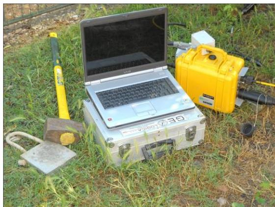
**Fig. 3** – Particolare della strumentazione utilizzata per le indagini sismiche.
