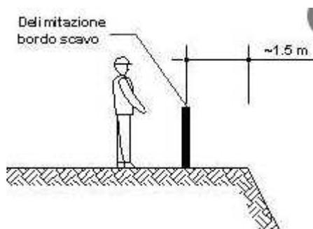
La scrivente non ritiene necessario l'ingresso di personale all'interno dello scavo, ma nel caso fosse necessario, sotto la vigilanza di un preposto potrà essere effettuato l'accesso dopo aver verificato la stabilità del terreno. Per l'ingresso e l'uscita dalla scavo:
